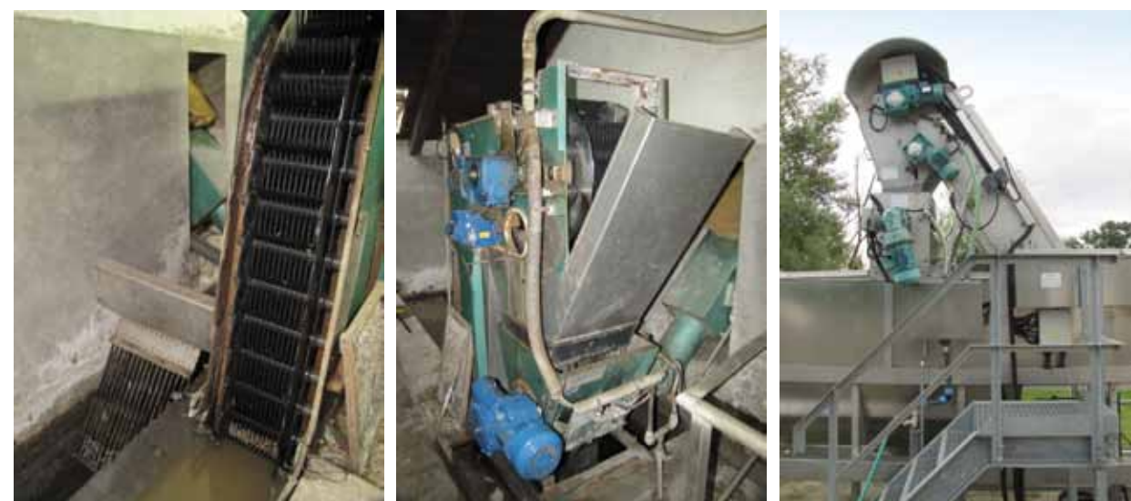
Obr. 4.239: Jemné česle – strojně stírané. Foto archiv VÚV.
