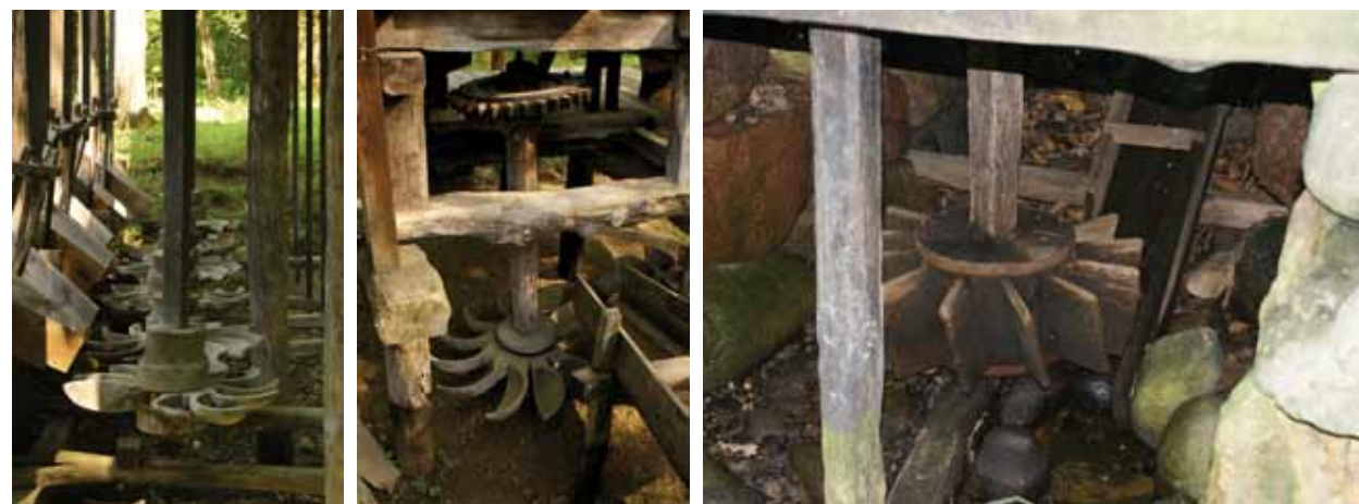
Obr. 4.173: Sibiú (Rumunsko), muzeum v přírodě Astra – vodní kolo horizontální. Foto Radim Urbánek, 2011.
